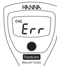
Tritt ein Problem bei der Kalibrierung auf, erscheint „-Err“. Überprüfen Sie, dass die Elektrode tief genug in der Lösung ist und dass Sie die richtige Lösung verwenden. Reinigen Sie die Elektrode 20 Minuten lang mit HI700682 Reinigungslösung. Dann spülen Sie die Elektrode mit destilliertem Wasser und konditionieren sie für weitere 30 Minuten in Aufbewahrungslösung bevor Sie die Kalibrierung erneut durchführen.
