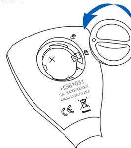
Zum Wechseln der Batterie (CR2032 Lithium-Batterie) entfernen Sie den Batteriefachdeckel an der Rückseite, indem Sie ihn gegen den Uhrzeigersinn drehen. Tauschen Sie die Batterie aus. Achten Sie darauf, dass der Pluspol nach oben zeigt. Hinweis: Achten Sie auf eine sichere Umgebung beim Batteriewechsel. Benutzen Sie nur die angegebenen Batterien. Achten Sie auf eine sachgemäße Entsorgung der Batterie.
