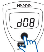
Im Messmodus des eingeschalteten Geräts drücken Sie die AN/AUS-Taste für einige Sekunden. Es erscheint nacheinander: OFF, CAL und zuletzt d08 auf dem Display. Lassen Sie die Taste los. Drücken Sie kurz die Taste bis Sie die gewünschte Abschaltzeit eingestellt haben. Sie haben die Wahl zwischen automatischer Abschaltung nach 8 Minuten (d08), 60 Minuten Nichtbenutzung (d60) oder deaktiviert (d-). Um in den Messmodus zurückzukehren halten Sie die Taste dauerhaft gedrückt.
