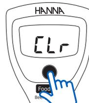
Öffnen Sie den Kalibriemodus und drücken Sie dann erneut dauerhaft die Taste. Es erscheint „Cl“ und die Kalibrierung ist gelöscht. Das Gerät setzt auf eine Standardkalibrierung zurück. Keine Symbole werden angezeigt.
