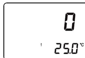
Hinweis: Das Display zeigt 0,0 bis eine Probenmessung erfolgt oder das Gerät ausgeschaltet wird.
