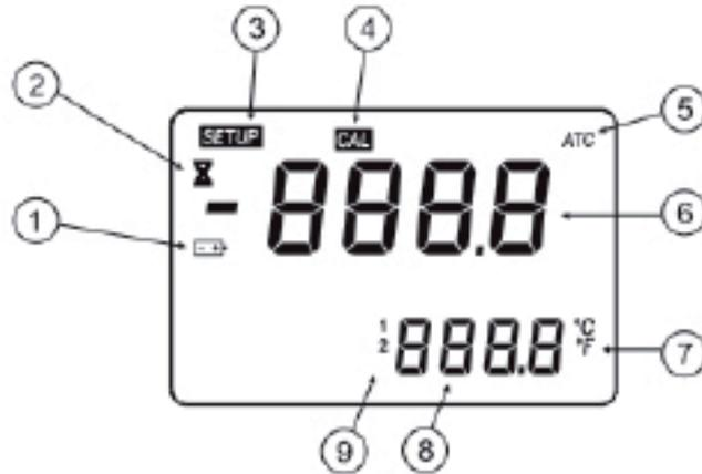
1. Batterie (blinkt bei schwacher Batterieladung)
