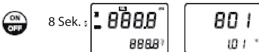
2. Halten Sie ON/OFF weiterhin gedrückt und drücken Sie gleichzeitig die Zero Taste. Nun wechselt die Temperatureinheit von °C zu °F oder umgekehrt.
